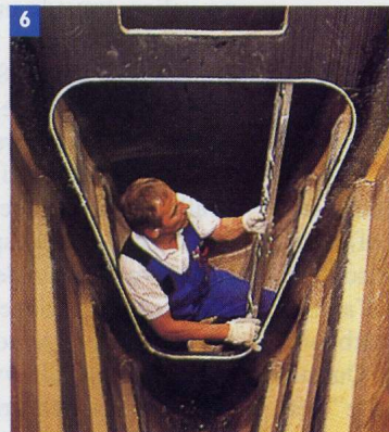
Foto 1 - Vista dalla testa d'albero della coperta in teak. Foto 2 - Winch elettrico della drizza randa. Foto 3 - Il gavone dell'ancora. Foto 4 - Il pozzetto con le due ruote. Foto 5 - Osterigio in composito a filo della coperta. Foto 6 - Paratia in composito (Nomex carbonio). Foto 7 - Il quadro motore. Foto 8 - I ripetitori del vento sulla colonnina del timone. Foto 9 - Le lande in composito.
