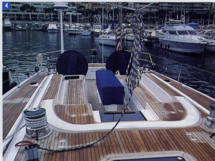
Foto 1 - Vista dalla testa d'albero della coperta in teak. Foto 2 - Winch elettrico della drizza randa. Foto 3 - Il gavone dell'ancora. Foto 4 - Il pozzetto con le due ruote. Foto 5 - Osterigio in composito a filo della coperta. Foto 6 - Paratia in composito (Nomex carbonio). Foto 7 - Il quadro motore. Foto 8 - I ripetitori del vento sulla colonnina del timone. Foto 9 - Le lande in composito.
